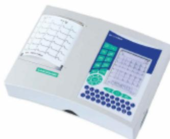
Electrocardiógrafo multicanal con pantalla grafica incorporada de 3, 6 y 12 canales; cabezal térmico de impresión (120 mm alta resolución) e interfase digital IRDA. Características estándar: registro manual, automático y temporizado del ECG; impresión de 3, 3+R y 6 canales; hasta 4 perfiles de uso configurables; teclado alfanumérico; sistema de alimentación doble red y batería recargable; guarda el ultimo registro de ECG en modo automático e imprime las copias que se deseen; fecha y hora.
